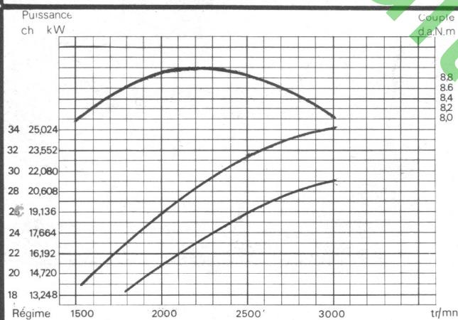
Na et Nb : puissances suivant norme 6270 garanties avec une tolérance de  $\pm 5\%$  après rodage.
